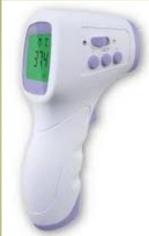
In mancanza di una macchina fotografica sensibile ai raggi infrarossi (il costo parte da alcune centinaia di euro ) si può usare un **pirometro** tipo il termoscaner che usiamo per misurare la temperatura corporea (ce ne sono però tipi che non funzionano sotto i 32°C)
