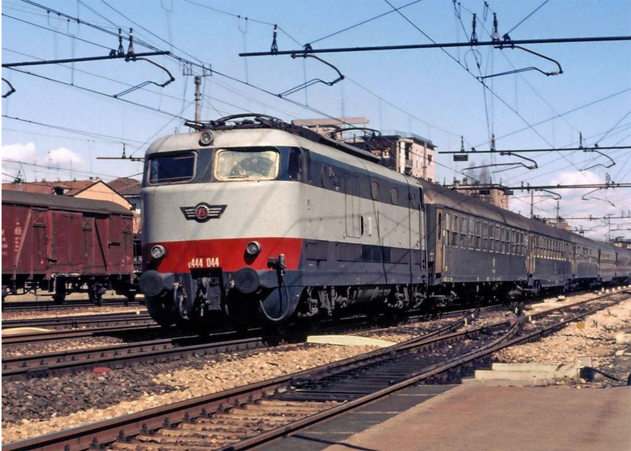
Prototipo e un lotto della E444, la più veloce locomotiva del suo tempo con 200 km/h, 1967.
