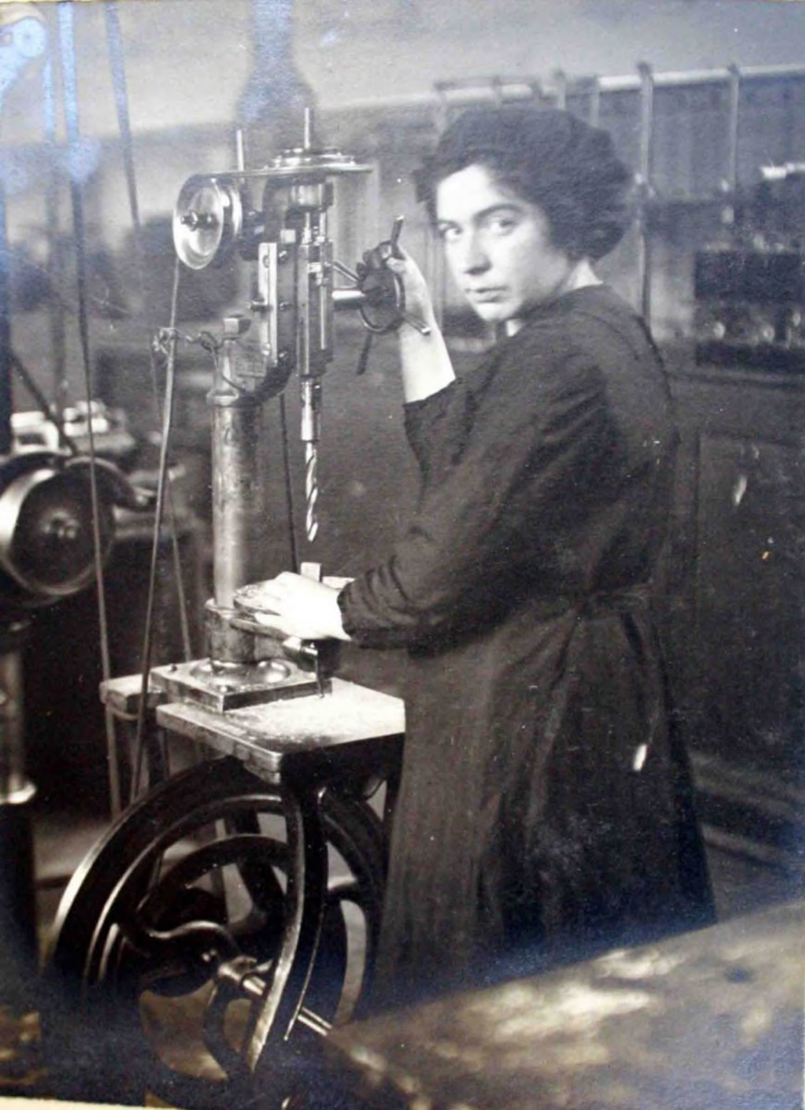
Elettricità, foratura al trapano di pezzi per apparecchi elettrici, 1915-16.
