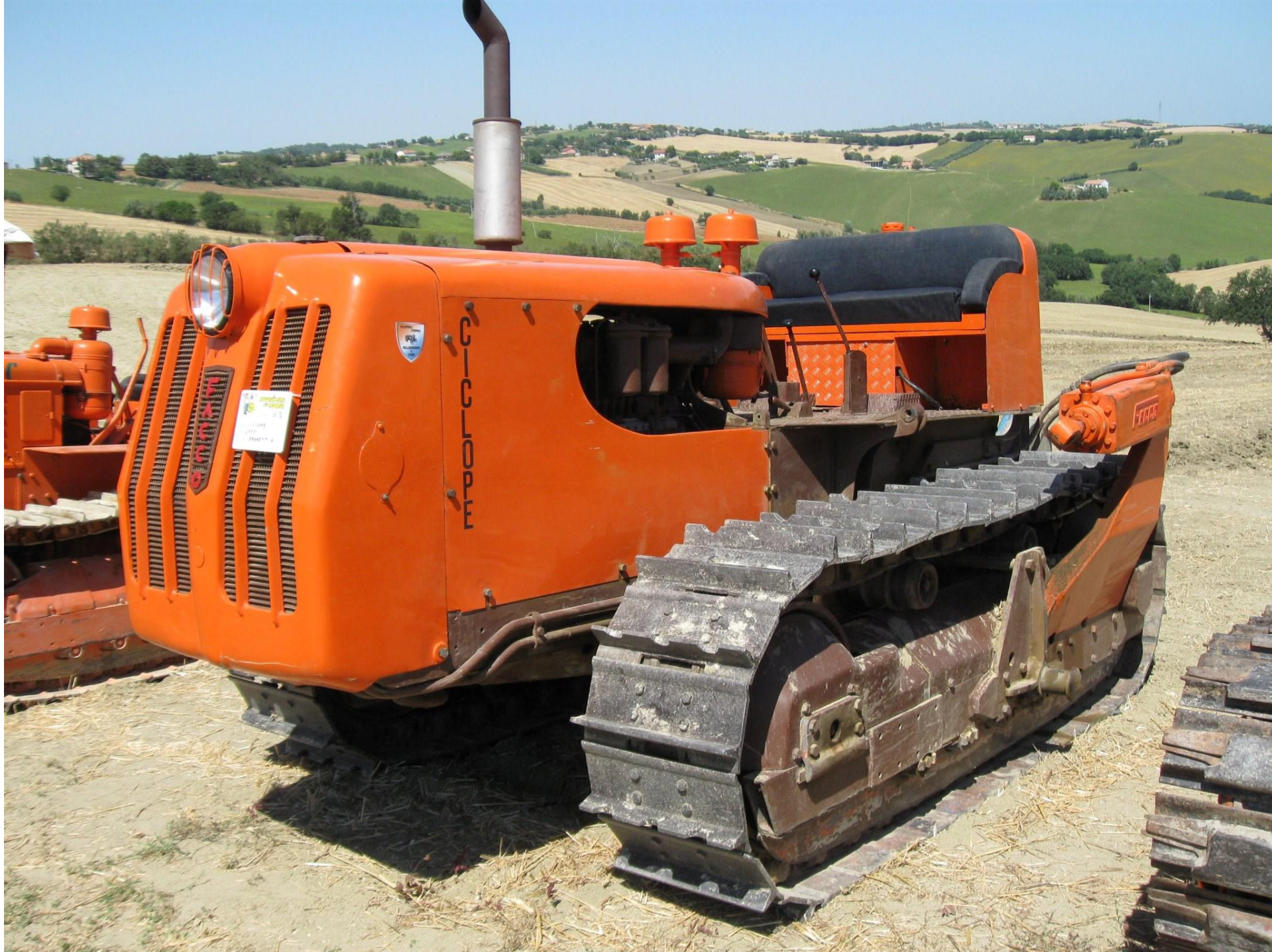
Trattore agricolo cingolato Ciclope, mosso da motore Fiat 682 o, in alcune versioni, Lancia Esatau. Adatto a lavori pesanti di aratura profonda. 1953.
