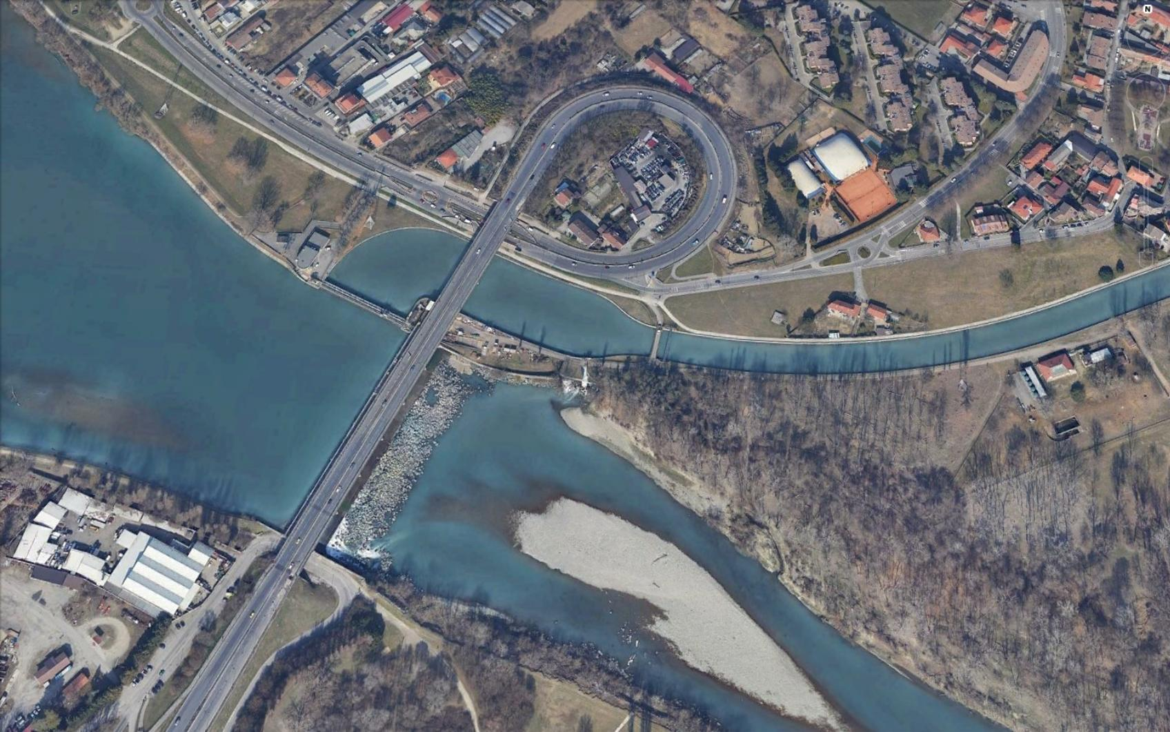
Il ponte-diga, ultimo ponte sul Po costruito a Torino, sulla direttrice di lungo Stura Lazio è stato realizzato tra il 1951 e il 1953, ad opera dell'Azienda Elettrica Municipale (attuale IREN). Nel 1969 il Comune effettuò un ampliamento per collegare il ponte a Strada Settimo e quindi abbreviare il percorso in direzione San Mauro. Il manufatto è costituito da undici campate formate da sei travi in cemento armato, di cui cinque sul Po, e misura 296,40 metri di lunghezza per 19,70 di larghezza.
