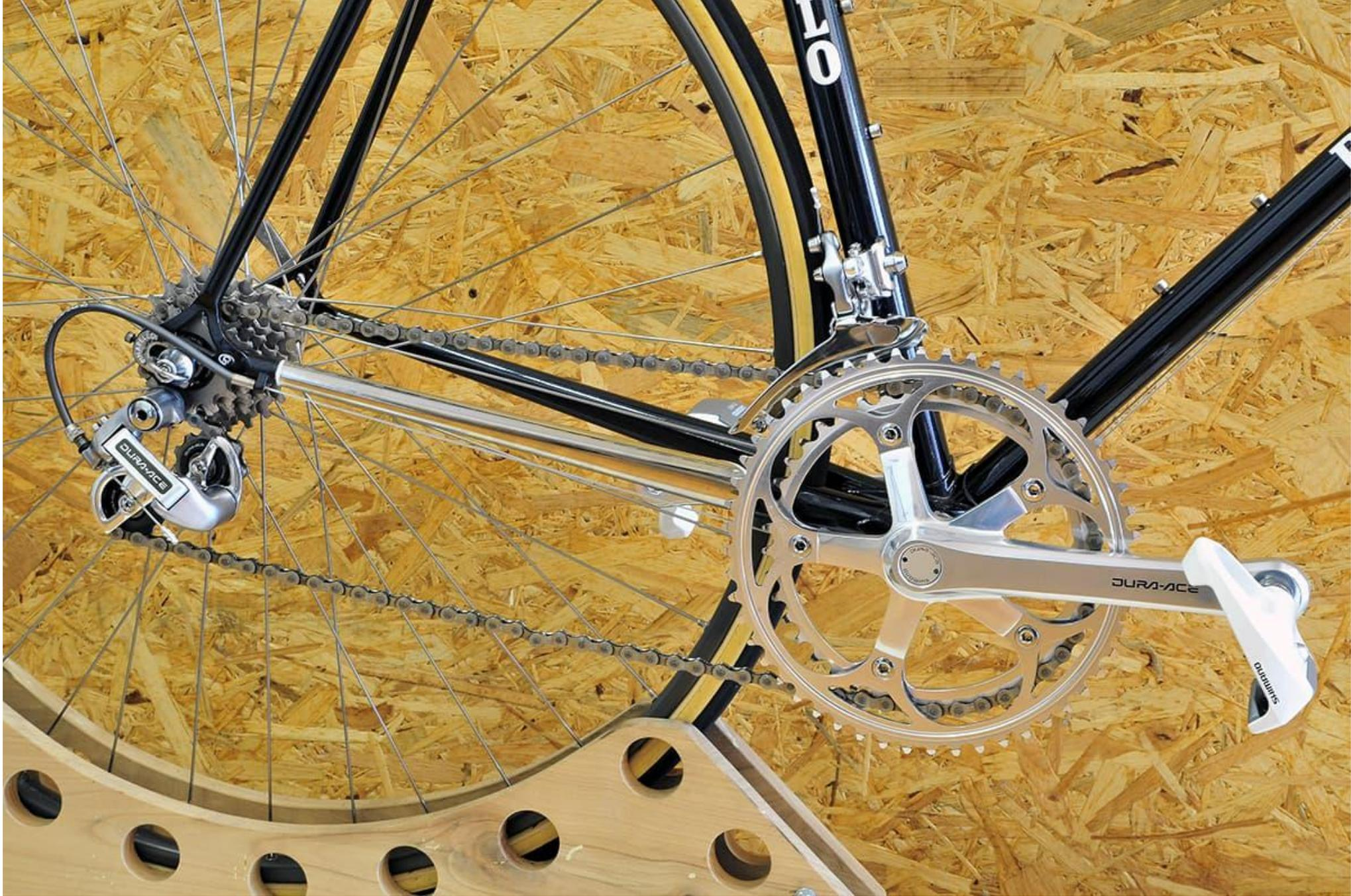
1984. Shimano presenta il Dura-Ace 7400 SIS. Il cambio è indicizzato: ad ogni scatto del comando corrisponde l'esatto tiraggio di cavo necessario al cambio di velocità. Le velocità disponibili diventano 5, 6, 7 e 8. I comandi passano dal tubo alle leve freno ai manettini.
