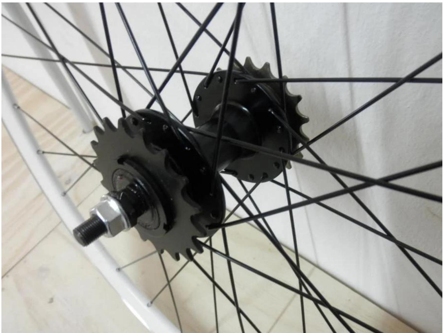
Primi '900. Le biciclette da corsa adottano i mozzi flip-flop, con 1 pignone su ogni lato. Il corridore scende, smonta e gira la ruota secondo necessità; un tendicatena mantiene la corretta tensione della catena.
