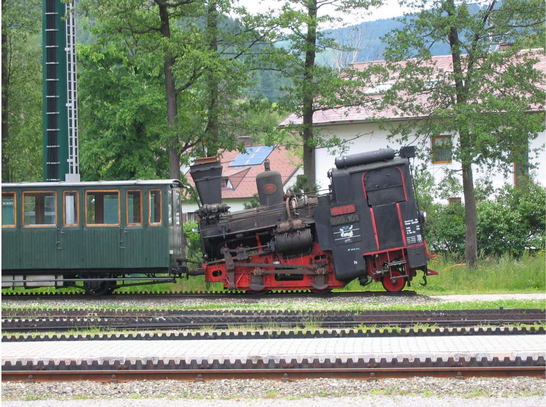
2005. Locomotiva SKGLB Z sulla Schneebergbahn (Austria), costruita nel 1896 e tuttora in esercizio per i treni storici. La caldaia è inclinata per rimanere approssimativamente orizzontale sulle pendenze della linea.
