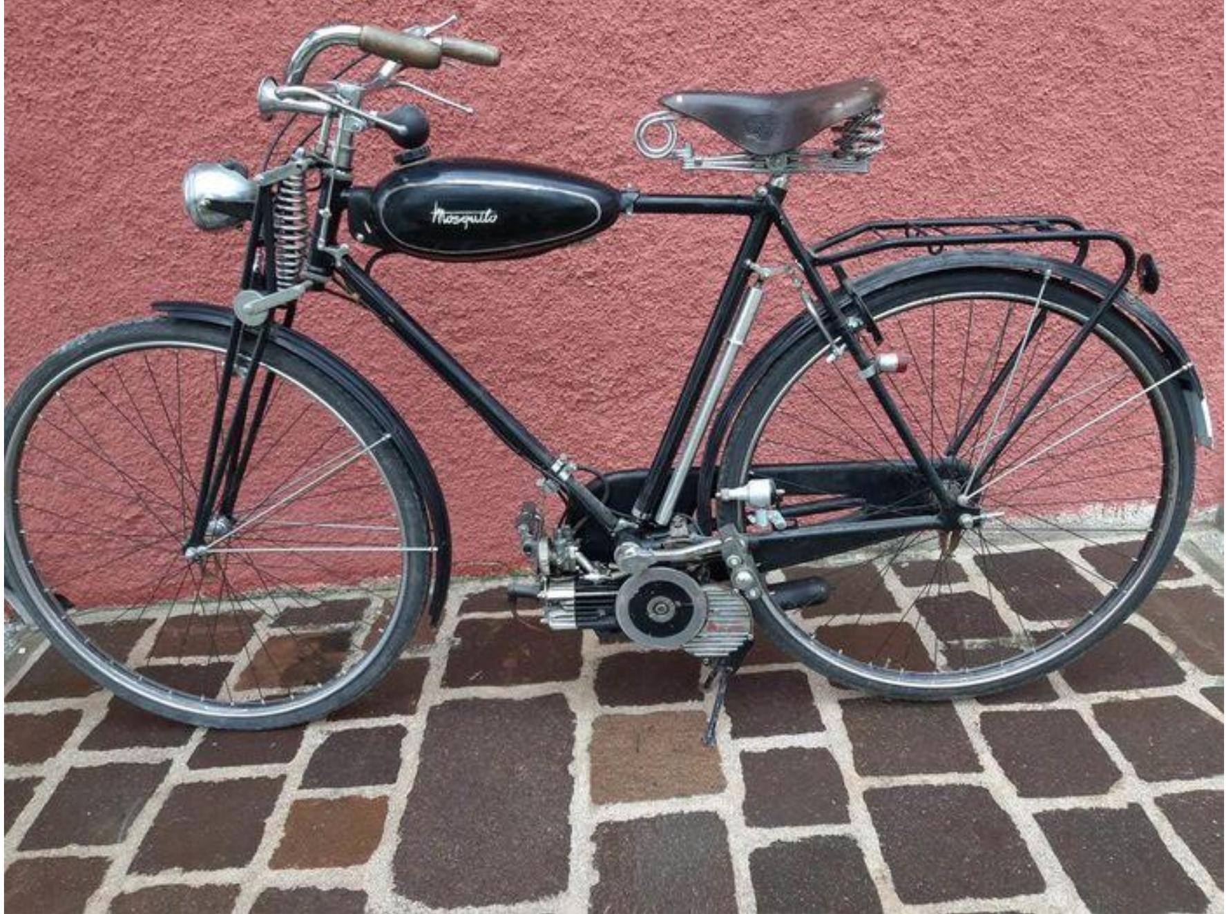
1950. Motorino Mosquito montato su bicicletta Bianchi. Costruito in 2 milioni di esemplari tra il 1946 e il 1960, è stato il più diffuso propulsore di questo tipo in Europa. La trasmissione del moto avviene tramite un rullo che agisce sul pneumatico posteriore.
