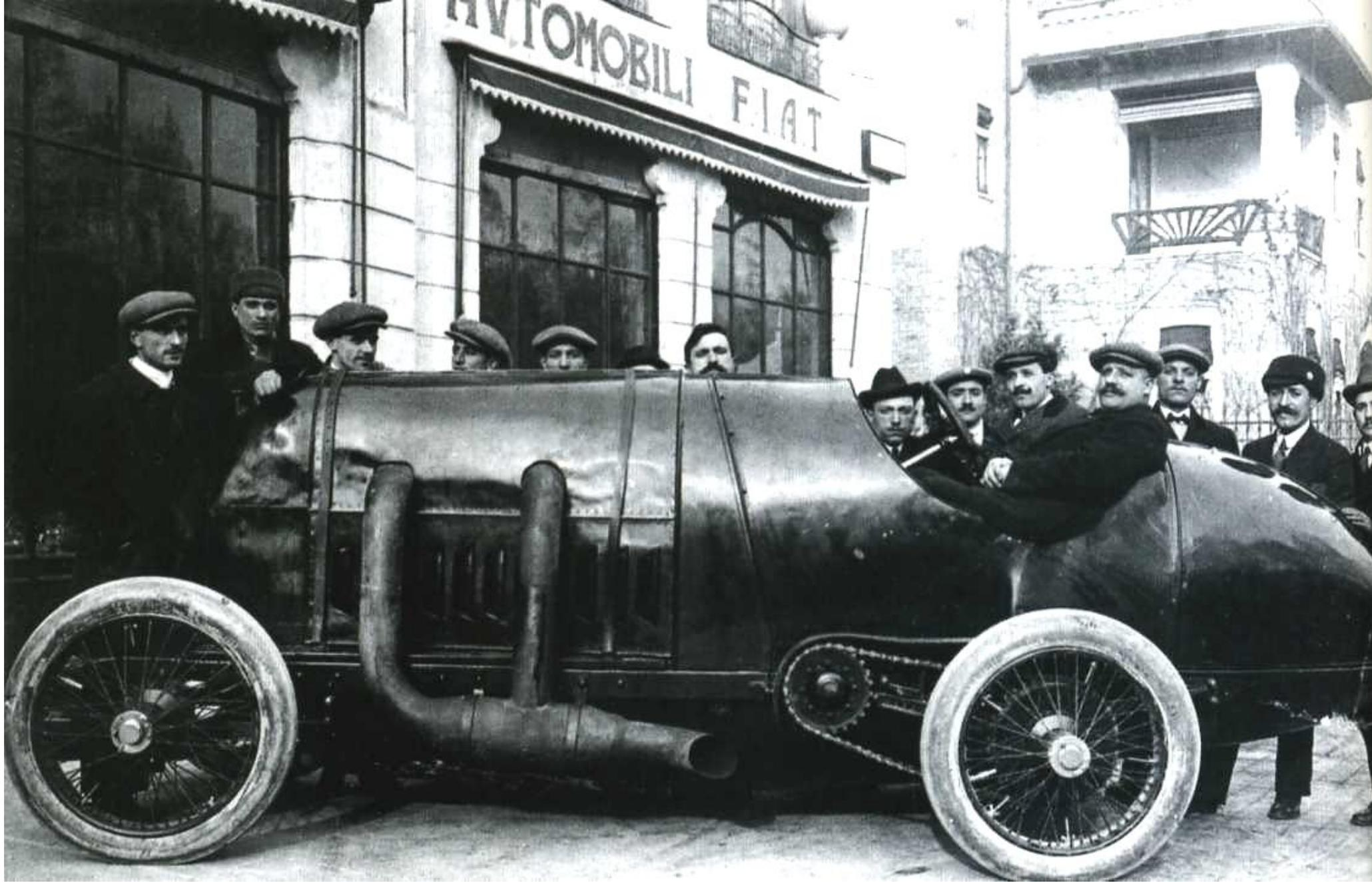
1911. La Fiat S76, 28 litri, 290 CV, 225 km/h, “la belva di Torino”. Costruita in due soli esemplari per conquistare il record di velocità, un telaio sopravvissuto è stato completato negli anni 2000 da un collezionista inglese, utilizzando il motore prestato incautamente dalla Collezione Capetti del Politecnico di Torino.
