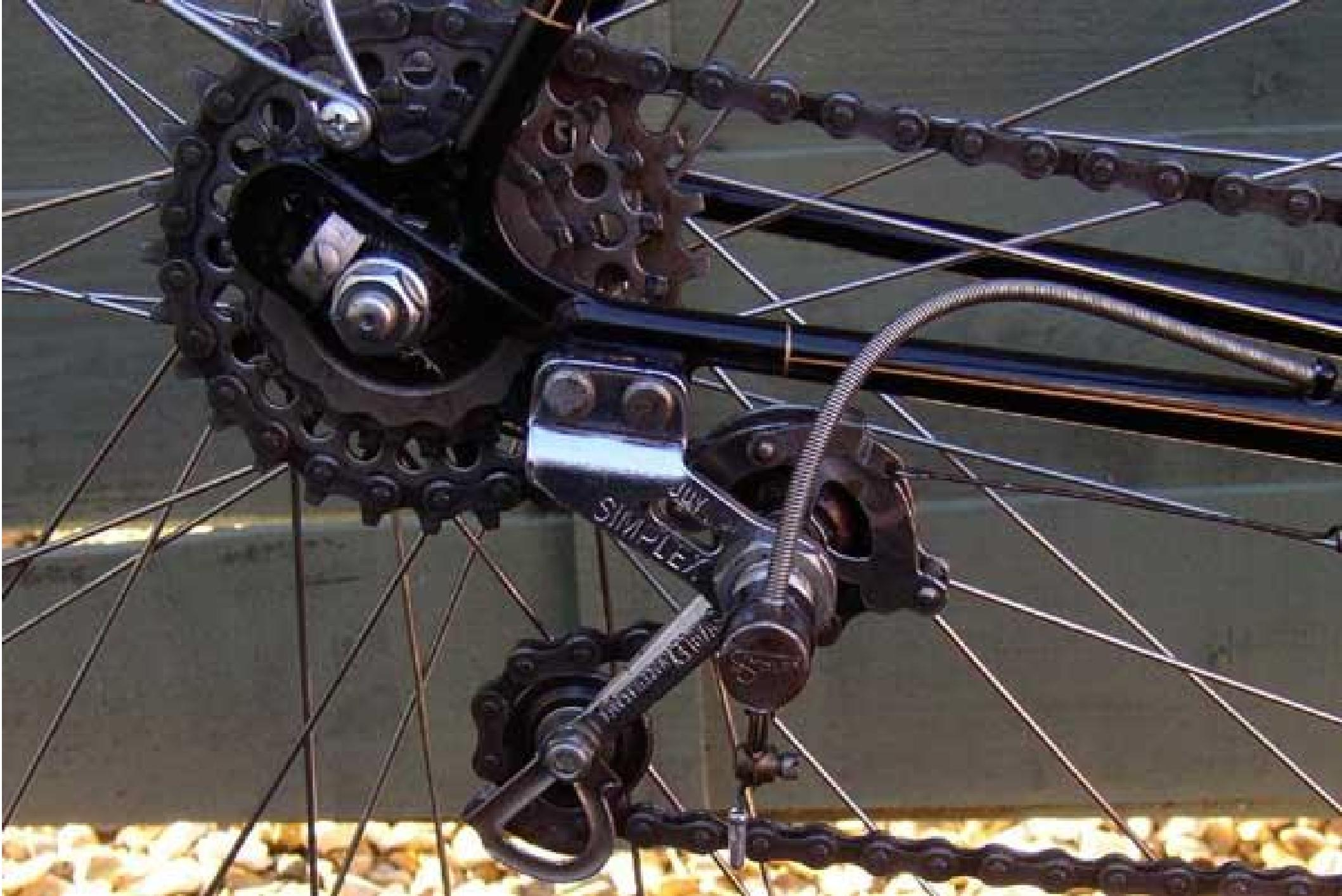
1948. Sviluppando un precedente modello anni '30, la Simplex produce un deragliatore a parallelogramma azionato da due cavi: uno per spostare e uno per tendere la catena.
