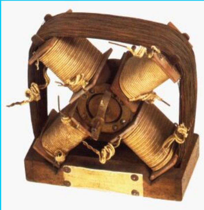
Si dedicò agli studi dell'elettromagnetismo e nel 1885 riuscì a dimostrare a un pubblico stupefatto l'esistenza di un campo magnetico rotante generato da due bobine fisse, ortogonali e percorse da correnti alternate della stessa frequenza e sfasate di  $90^\circ$ . La scoperta del campo magnetico rotante fu esposta ufficialmente in una nota presentata all'Accademia delle Scienze di Torino solo il 18 marzo 1888.
