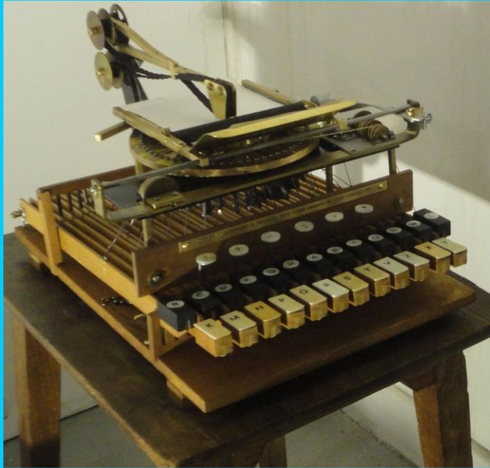
Il cembalo scrivano presentava il telaio portafoglio mobile, il nastro inchiostatore, un dispositivo per fissare l'interlinea e il campanello indicatore di fine riga. Era composta da quasi 600 pezzi in legno e circa 100 in ottone.
