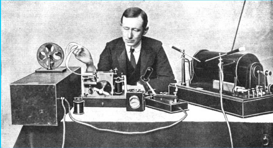
Marconi sostituì il dipolo verticale di Hertz con un filo verticale collegato a una lastra di metallo, con il terminale opposto connesso a terra (antenna di Tesla). Dalla parte del ricevitore, egli sostituì lo spinterometro con un coesore di polvere di metallo. Marconi emise segnali radio per un miglio alla fine del 1895.
