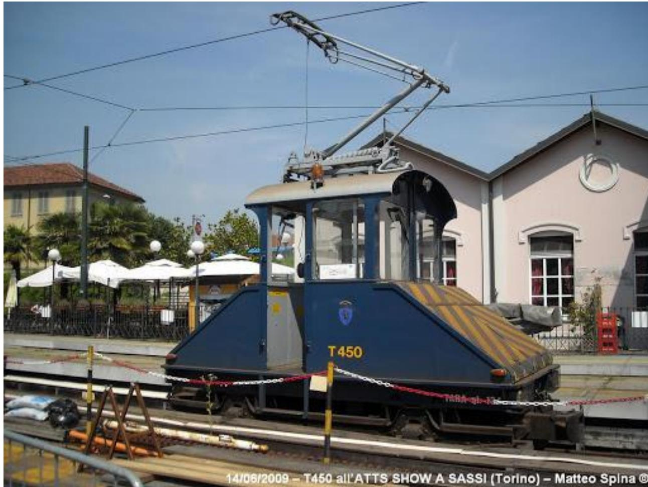
Il mezzo di servizio ora utilizzato per le manovre sul piazzale è stato realizzato nel 1957 riutilizzando la meccanica di un vecchio tram del 1902.
